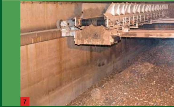
7 Rotteguteintrag in den Tunnel mit dem Tunneleintragsgerät (TEG)
