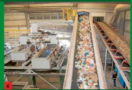
6 Zuführbänder mit hochkalorischer Fraktion (links) und Rottegut (rechts)
