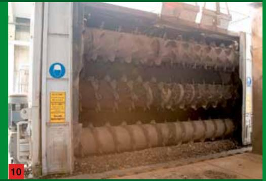
10 Rottegutaustrag aus dem Tunnel mit dem Tunnelaustragsgerät (TAG)
