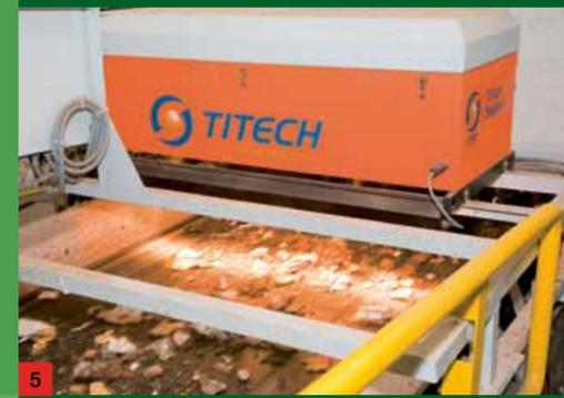
5 Kunststofftrennung mit Auto Sort (Nah-Infrarot-Sensortechnik)
