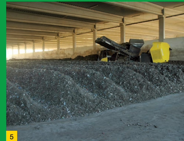
5 Verbesserung der Durchlüftung in der Intensiv- und Nachrotte
