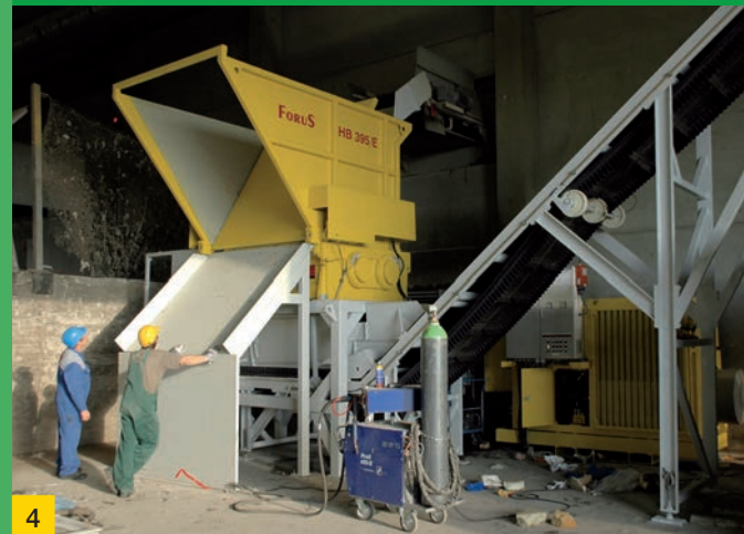
4 Leistungssteigerung der mechanischen Aufbereitung durch die Installation eines Schredders für den Siebüberlauf
